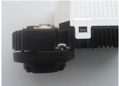
2) Разъедините передачу нажатием на красную кнопку и поверните шток в крайнее положение против часовой стрелки. Установите ограничительное кольцо, сориентировав его указатель в направлении значка «0» на корпусе адаптера.
