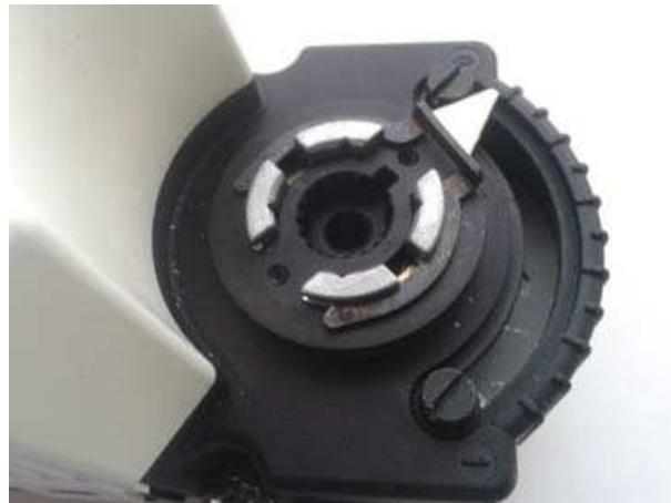
5) Установите ручку для ручной регулировки степени открытия трехходового клапана.
