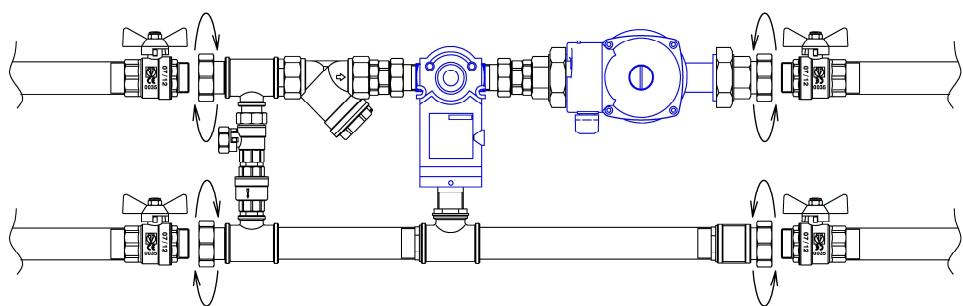
**Возможна правая и левая сторона подключения.** Благодаря тому, что соединения основных элементов смесительных узлов выполнены на быстроразъемных соединениях типа «американка», можно самостоятельно изменить сторону подключения смесительного узла с правой на левую;
