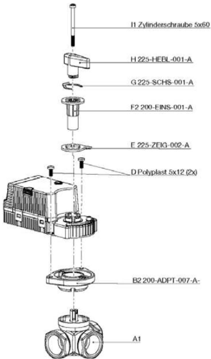
6) Установите привод на трехходовой клапан с учетом следующих требований.
