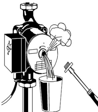
**ЗАПУСК:** По завершении монтажа заполнить систему и произвести выпуск воздуха перед запуском циркуляторного насоса. Запустить насос на максимальной скорости.
