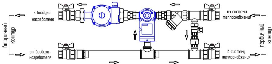
4. Если теплоносителем является вода, узел устанавливается только внутри помещения, где поддерживается постоянная температура, которая не должна понизиться до точки замерзания.
