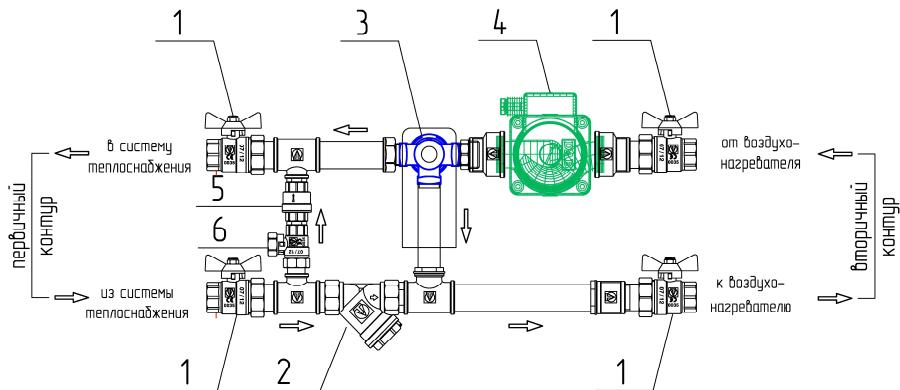
Рисунок 5. Схема смесительного узла обратной конфигурации
