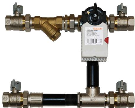
Смесительные узлы серии SUM(C)-N применяются в системах вентиляции для регулирования мощности водяных охладителей посредством 3-ходового клапана с приводом, который обеспечивает разделение прямого холодоносителя. Данная схема обеспечивает постоянный расхода холодоносителя в первичном контуре (рис.2.4)
