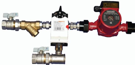
Смесительные узлы серии SUM(H)-U применяются в системах вентиляции для регулирования мощности водяных нагревателей посредством 3-ходового клапана с приводом, который обеспечивает смешивание прямого и обратного теплоносителя. Данная схема обеспечивает постоянный расхода теплоносителя во вторичном контуре (рис.2.3)
